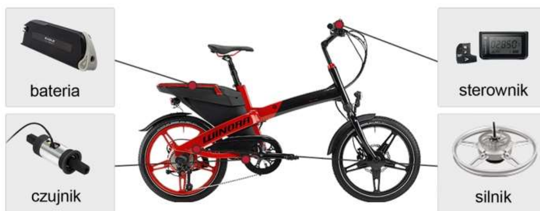
Rysunek 3. Kluczowe elementy roweru elektrycznego: silnik – bateria – sterownik Źródło: http://blog.rower.com.pl/jak-dziala-rower-elektryczny/ [dostęp: 18.01.2019].
