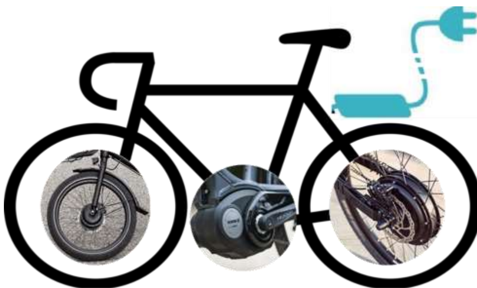
Rysunek 4. Trzy rodzaje rozmieszczenia napędu w rowerach elektrycznych.
