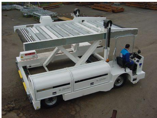
Rys. 8. Transporter cargo do palet i kontenerów lotniczych
