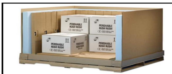
Rys. 5. Przekrój Pallet Shipper'a w trakcie tworzenia jednostki ładunkowej
