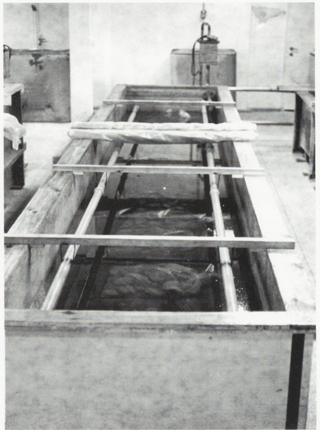
3. Jedna z wanien wykonana z żywicy poliestrowej i włókna szklanego, wykorzystywana do czyszczenia i impregnacji czołna w I etapie konserwacji
