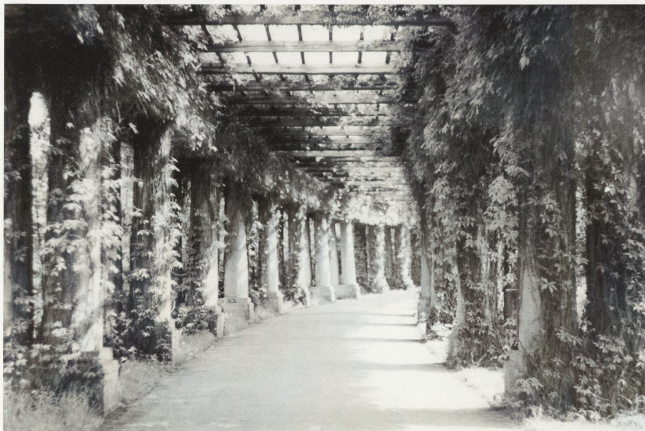
5. Wrocław — Park Szczytnicki. Konstrukcję pergoli tworzy 300 potężnych podwójnych słupów przykrytych drewnianą kratownicą. Fot. B. Jackiewicz
