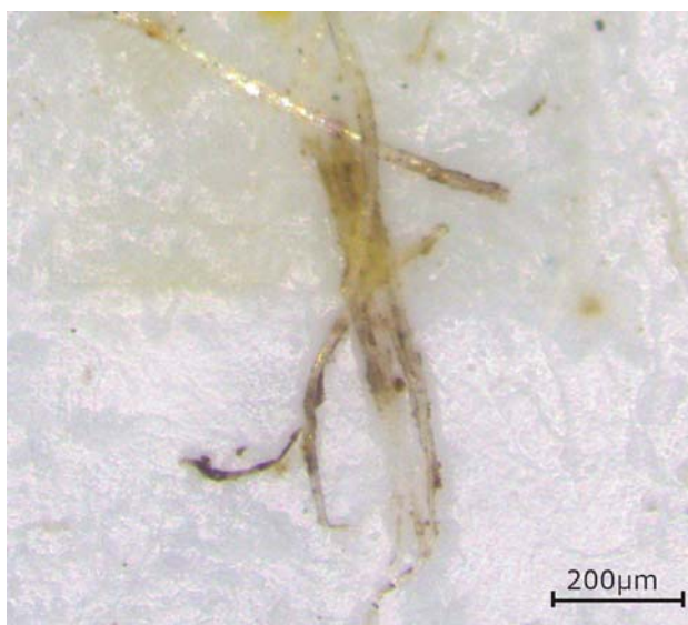
Il. 8. Wygląd analizowanej próbki druku osadzonego na włóknach (mikroskop optyczny, światło odbite)
