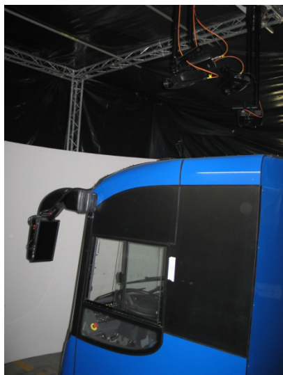
Ryc. 2. Symulator z ekranem walcowym – widoczna kabina, cylindryczny ekran i układ projekcyjny (źródło: autor zdjęć G. Gudzbeler)
