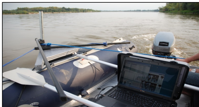
Rys. 8. Zintegrowany system hydrograficzny SGGW podczas pracy [4]
