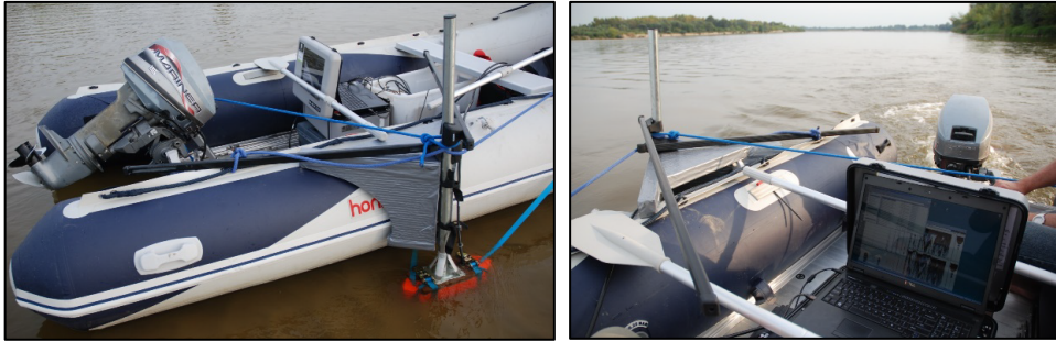
Rys. 2. Zestaw hydrograficzny złożony z echosondy zintegrowanej z odbiornikiem DGPS
