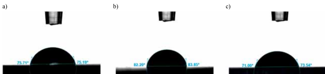
Fig. 5. View of the saline droplet on the MED610 surface for the print direction (a) 0°, (b) 45°, (c) 90° Rys. 5. Widok kropli soli fizjologicznej na powierzchni MED610 dla kierunku wydruku (a) 0°, (b) 45°, (c) 90°
