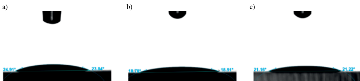
Fig. 4. View of the diiodomethane droplet on the MED610 surface for the print direction (a) 0°, (b) 45°, (c) 90° Rys. 4. Widok kropli diiodometanu na powierzchni MED610 dla kierunku wydruku (a) 0°, (b) 45°, (c) 90°
