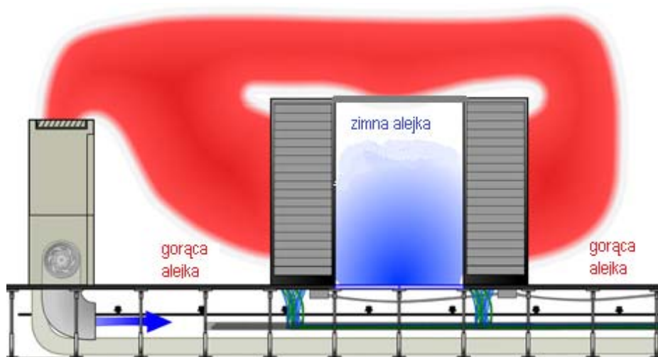
Rys. 1. Wykorzystanie podniesionej podłogi technicznej do zasilania zimnym powietrzem zabudowanej alejki między rzędami szaf przemysłowych zawierających elementy części rdzeniowej przykładowej sieci komórkowej [4].
