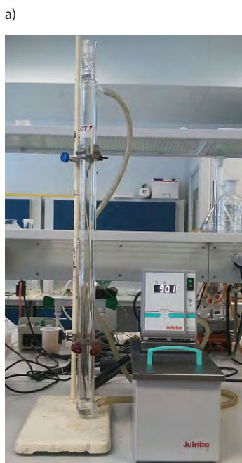
Rys. 3. Aparatura do otrzymywania ziaren sferycznych UO_2 przy zastosowaniu połączonych metod CSGP i żelowania wewnętrznego stosowana w Instytucie Chemii i Techniki Jądrowej (a). Formowanie kropelek żelu igłą ze stali nierdzewnej (b)
