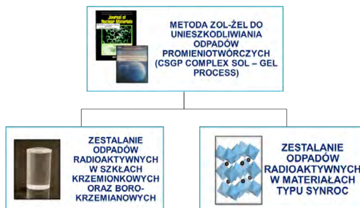
Rys. 7. Metody zestalania odpadów promieniotwórczych opracowane w IChTJ Fig. 7. Radioactive waste immobilization methods developed at INCT
