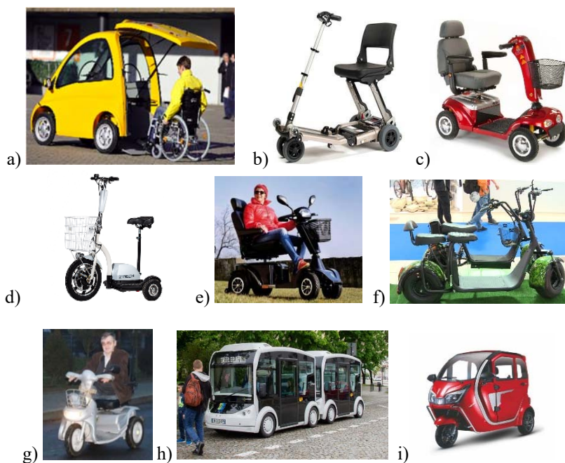
Rys. 16. Pojazdy elektryczne dla osób z mniejszą sprawnością w poruszaniu się: a) samochód dla niepełnosprawnych Kenguru; b) skuter podróżny; c) skuter elektryczny; d) pojazd trójkołowy ZT-16; e) skuter inwalidzki; f) osobisty pojazd elektryczny; g) skuter elektryczny Breeze 3; h) elektryczne mikrobusy francuskiej firmy Lohr Industrie mogą pomieścić 16-20 osób, prędkość do 40 km/h przy dystansie do 120 km; i) pojazd elektryczny – motorower – inwalida – microcar.
