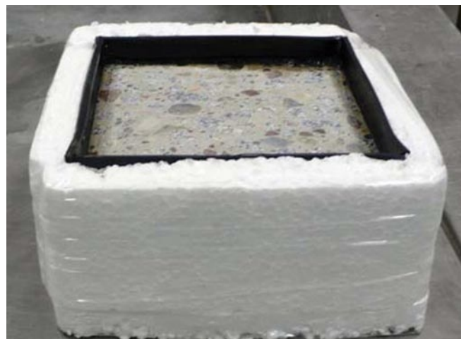
Rys. 2. Przygotowana próbka betonu wałowanego przed badaniem mrozoodporności [3]
