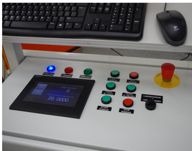
Rys. 4. Widok pulpitu sterującego wraz z ekranem HMI umożliwiającym wybór parametrów wykonywanych eksperymentów
