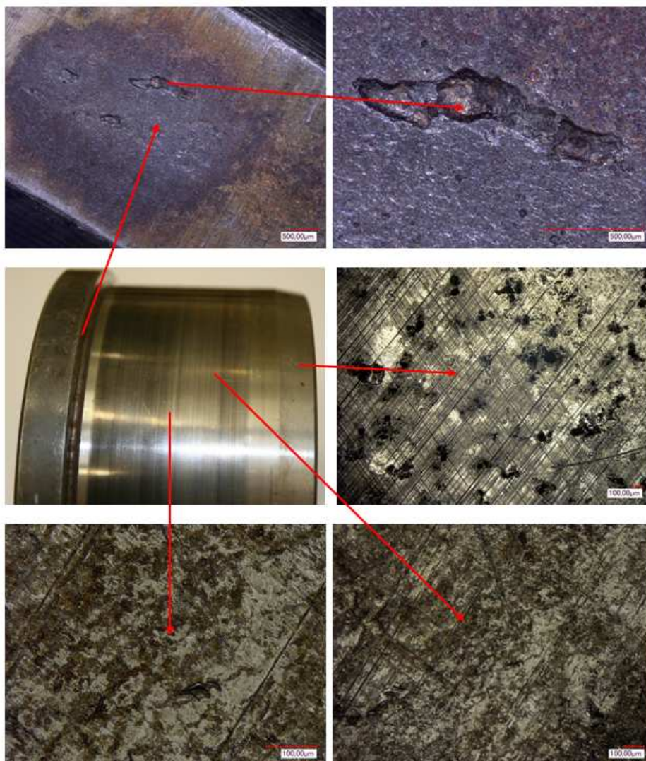
Rys. 6. Charakterystyczne strefy powierzchni zużycia wielkogabarytowych łożysk tocznych po eksploatacji (po przebiegu około 600.000 km): przykładowe miejsca korozji wżerowej
