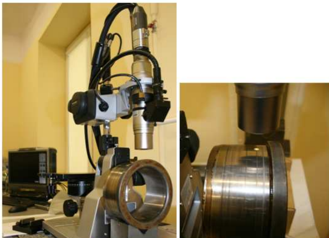
Rys. 4. Widok mikroskopu optycznego ze światłowodową transmisją obrazu podczas obserwacji topografii powierzchni bieżni pierścienia wewnętrznego wielkogabarytowego łożyska tocznego
