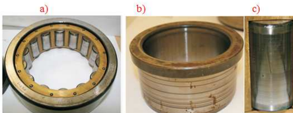
Rys. 3. Widok wielkogabarytowego wałeczkowego łożyska tocznego i jego elementów eksploatowanego w maźnicach kół wagonowych (600 tys. km); a – pierścień zewnętrzny łożyska, koszyk i wałeczki, b – widok pierścienia wewnętrznego ze zużytą bieżnią, c – wałeczek po eksploatacji
