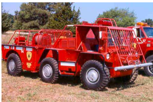
Rys. 1. Pojazdy specjalne stosowane w akcjach ratowniczych jednostek straży pożarnej: a) pojazd Gamma Goat (USA) w wersji pożarniczej, b) Supacat (Wielka Brytania) w akcji
