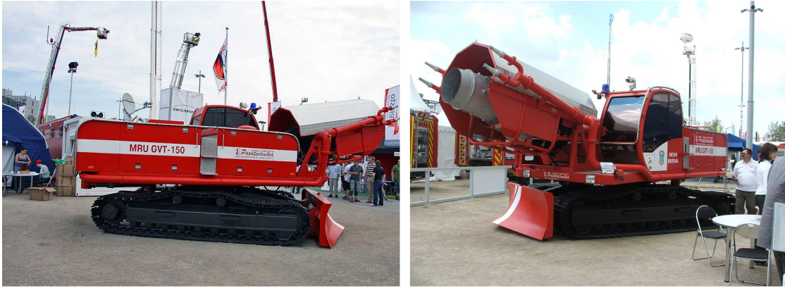
Rys. 7. Gąsienicowy robot gaśniczy ( v_{max}=3\text{km/h} , m=17500\text{kg} , Q=150\text{ dm}^3/\text{s} ) [9]
