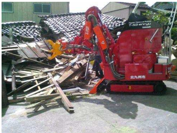
Rys. 9. Japoński robot wsparcia na bazie mini-koparki
