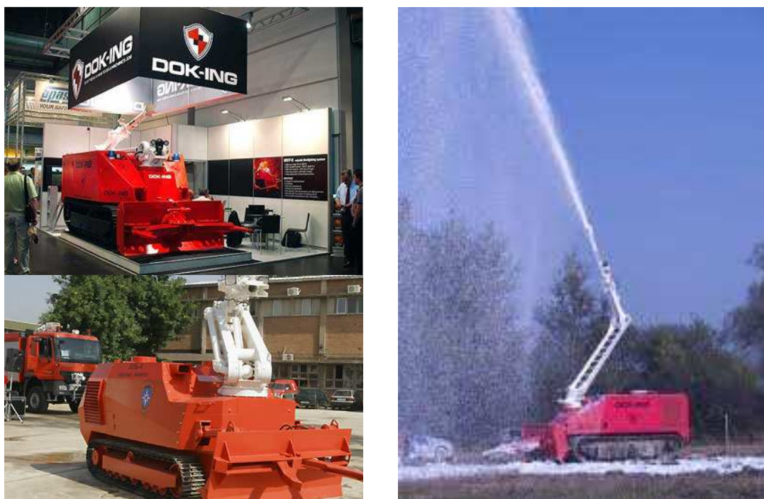
Rys. 6. Chorwacki robot gaśniczy wyposażony w działko wodne na manipulatorze
