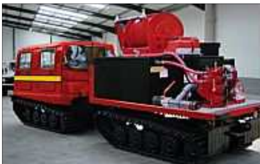
Rys. 2. Pojazdy specjalne stosowane w akcjach ratowniczych jednostek straży pożarnej: a) Heglund Bv-206 (Szwecja) z zestawem wyposażenia, b) Supacat (Wielka Brytania) przemieszczający się po utwardzonej nawierzchni
