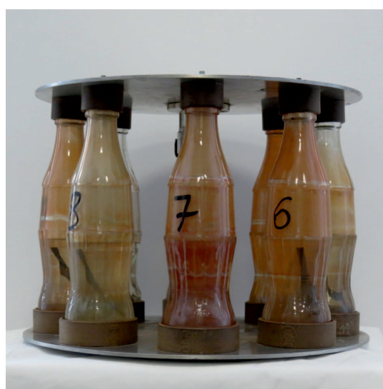
Rys. 3. Stanowisko do badań korozyjnych wheel test według NACE 1D182 (2005) – fotografia aparatu obrotowego oraz zestawu butelek testowych po badaniu korozyjnym
