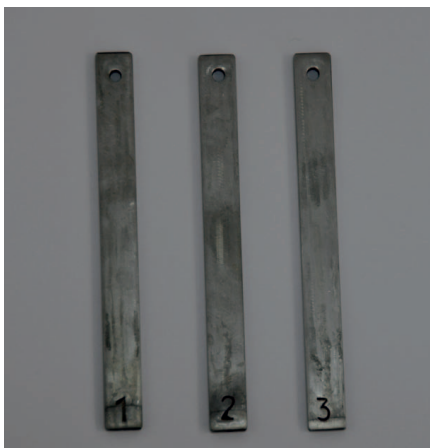
Rys. 8. Fotografia próbek ze stali po badaniu korozyjnym (fot. A. Stachowicz)
