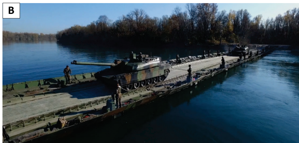
Rys. 3. Zmotoryzowany park pontonowy opracowany przez firmę CNIM Systèmes Industriels wykorzystywany jako prom (A) i most (B) w warunkach wysokich stanów wody w korycie (fot. CNIM Systèmes Industriels)
