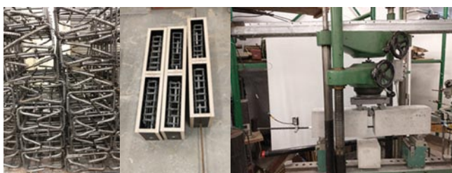
Rys. 2. Zbrojenie zestawu belek, szalunek i stanowisko do badania przyczepności prętów zbrojenia; źródło: opracowanie własne
