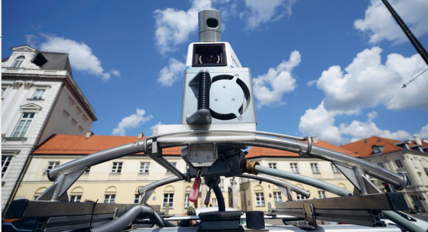
System Cyclomedia składa się z lidar, 5 kamer, odbiornika GNSS oraz jednostki IMU
