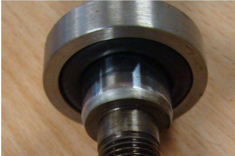
Rys. 5. Pierścień uszczelniający w testowym gnieździe
