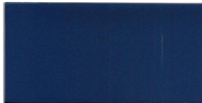
Rys. 1. Próбка stalowa z renowacyjną powłoką akrylową
