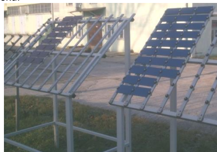
Rys. 3. Próbki powłok lakierniczych na stojakach umiejscowionych w stacji klimatycznej
