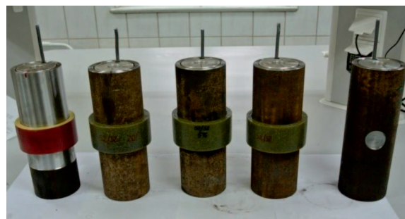
Rys. 1. Zestawy odcinków perfogeneratora uzbrojonych w paliwo prochowe typu Szafir/Szmaragd ze zmieniającą się zawartością materiału podsadzkowego
