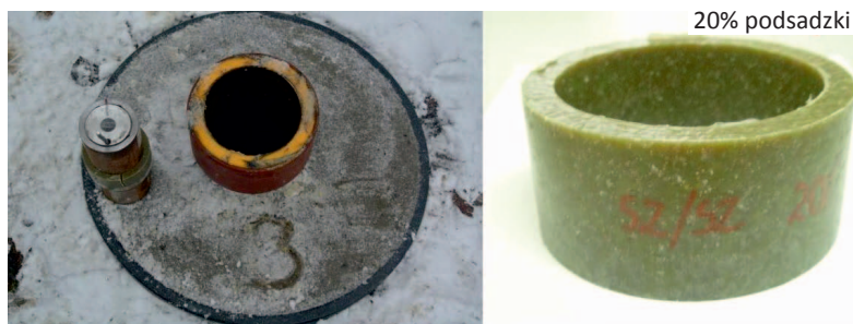
Rys. 5. Widok uzbrojonego perfogeneratora. Zastosowano płaszcz paliwa z zaprasowanej mieszanki granulacyjnej propelantów typu Szafir i Szmaragd z dodatkiem 20% materiału podsadzkowego
