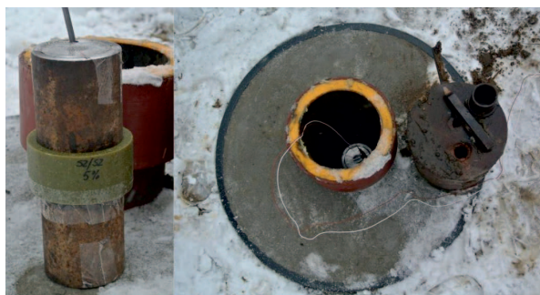
Rys. 3. Widok uzbrojonego perfogeneratora. Zastosowano płaszcz paliwa z zaprasowanej mieszanki granulacyjnej propelantów typu Szafir i Szmaragd z dodatkiem materiału podsadzkowego w ilości 5% udziału wagowego
