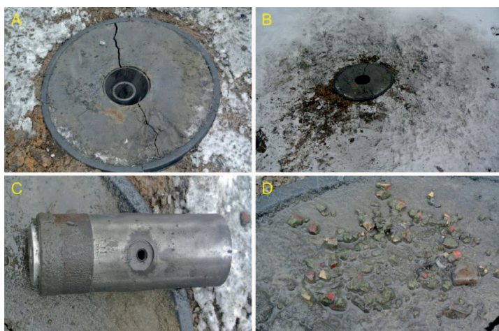
Rys. 8. Efekt testu czwartego; A – duża szczelina dwuskrzydłowa mocniej rozwarta w osi działania ładunku kierunkowego, B – niewielki rozrzut gruntu, wskazujący, że nastąpiła częściowa ucieczka gazów prochowych dolną częścią modelu betonowego, C – wyjęta po strzale rura korpusowa z widoczną dobrą jakością perforacją, D – wydobyte z dna resztki niespalonego pierścienia paliwowego
