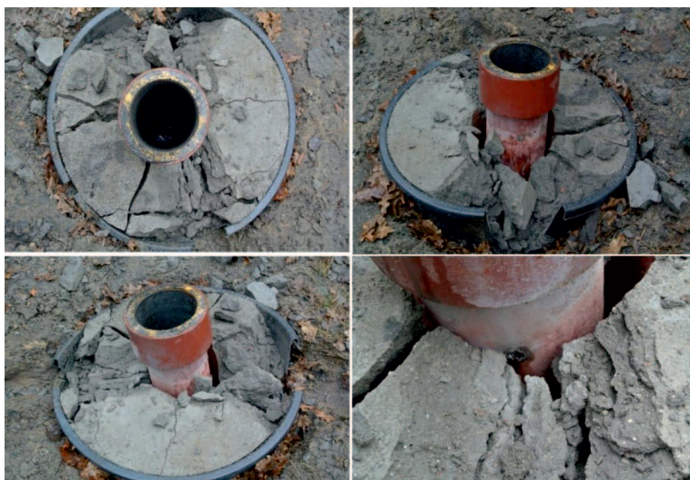
Rys. 2. Rezultat strzału w eksperymencie pierwszym. Widoczne liczne spękania i szczeliny. Wyraźny otwór perforacyjny i szczelina w jego osi
