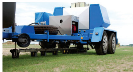
Rys. 11. Badanie ugięciomierzem HWD
