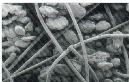
Rys. 4. Mieszanka piasku, gleby rodzimej oraz włókien polimerowych – struktura [12]
