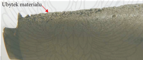
Rys. 8. Łopátka ze stali X20Cr13 ostatniego stopnia turbiny typu TC 1201 — widoczny ubytek materiału w obszarze krawędzi natarcia [23]
