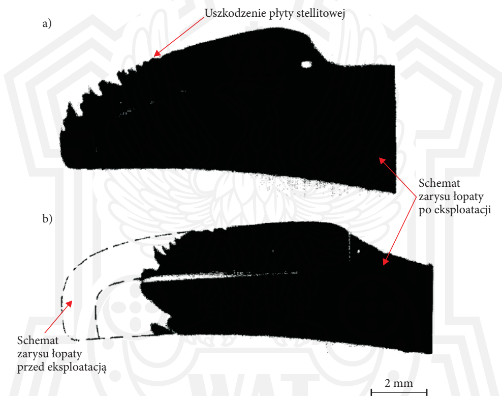
Rys. 10. Schemat zarysu łopat wirnika ostatniego stopnia NP z turbiny 210 MW: a) uszkodzenie płyty stelliteowej w drugim obszarze erozji; b) uszkodzenie krawędzi natarcia łopaty z zaznaczonym linią przerywaną kształtem łopaty po ok. 10 tys. godzin eksploatacji [30]
