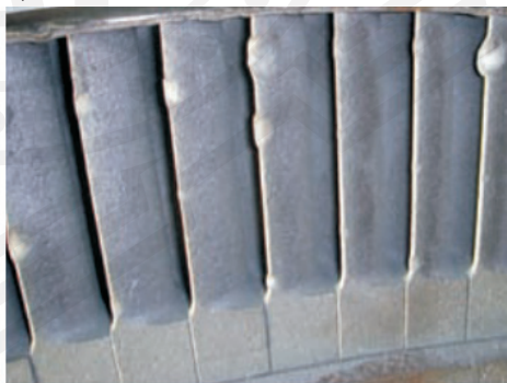
Rys. 22. Uszkodzenia krawędzi wylotowej tzw. ciałem obcym znajdującym się w komorze wirnika: a) turbina 120 MW, wirnik NP, b) turbina 200 MW, wirnik WP [28]
