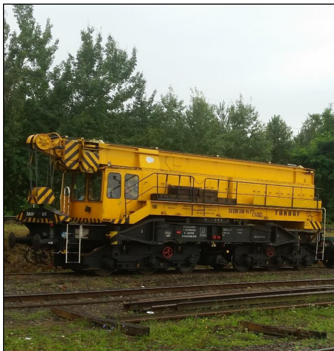
Rys. 1. Żuraw kolejowy TAKRAF ZU-EDK-300
