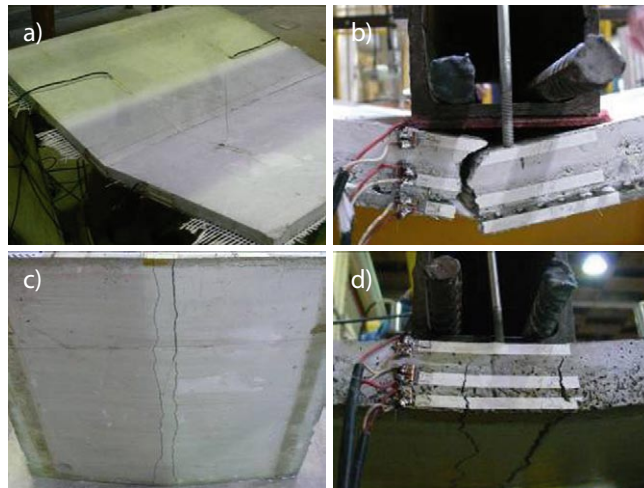
Rys. 5. Obrazy zniszczenia płyt: a) i b) zbrojonych siatką z włókna szklanego, c) i d) zbrojonych tradycyjnie prętami stalowymi
