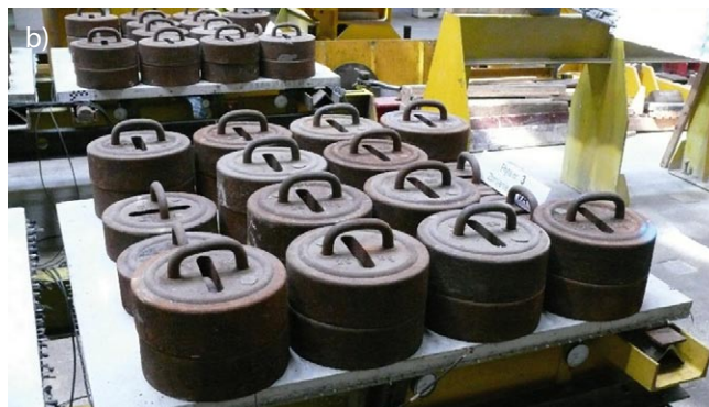
Rys. 7. Badania długotrwałe płyt: a) obciążenie ok. 5 \text{ kN/m}^2 , b) obciążenie ok. 7 \text{ kN/m}^2
