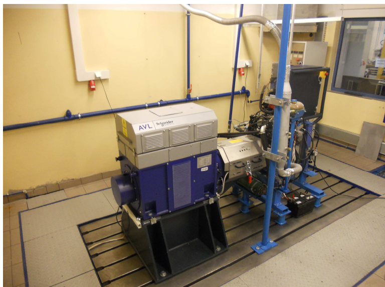
Rys. 2. Silnikowe stanowisko hamulcowe wyposażone w hamownię dynamiczną AVL DynoRoad 120 kW
