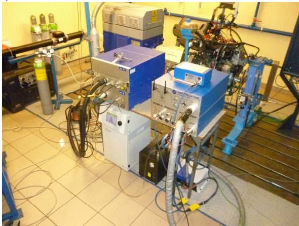
Rys. 5. Aparatura do pomiaru emisji CO 2 : a) przyrząd SEMTECH DS – pierwszy z prawej, b) przepływomierz do pomiaru masowego natężenia przepływu gazów wylotowych
