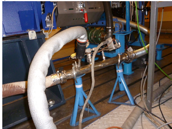
Rys. 5. Aparatura do pomiaru emisji CO 2 : a) przyrząd SEMTECH DS – pierwszy z prawej, b) przepływomierz do pomiaru masowego natężenia przepływu gazów wylotowych
