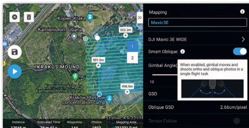
Rys. 8. Kierunki wykonywania zdjęć podczas misji typu Smart Oblique w Mavic 3E
