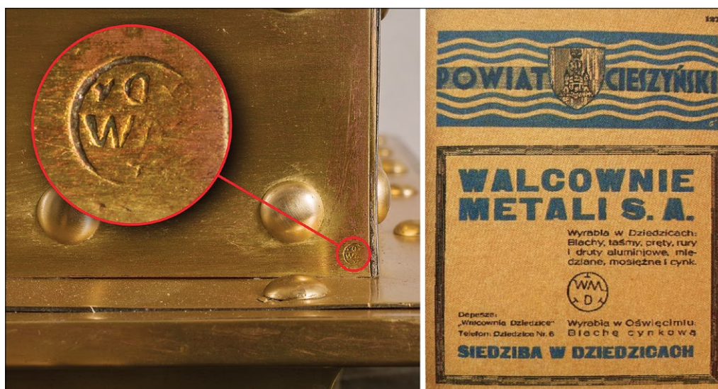
Ryc. 4. Znak Walcowni Metalu Działoszka na blasze sarkofagu oraz na pierwszej reklamie Walcowni w prasie śląskiej; oprac. A. Kiszczak Fig. 4. Mark of the Działoszka Metal Rolling Mill (Walcownia Metali Działoszka) on a metal plate of the sarcophagus and in the Rolling Mill's first advertisement in Silesian press; by A. Kiszczak
