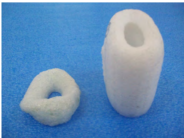
Fot. 1. Próbkę polietylenowej pianki: nienapromieniowanej i modyfikowanej radiacyjnie dawką 50 kGy po wygrzewaniu przez 10 minut w temperaturze 195°C
