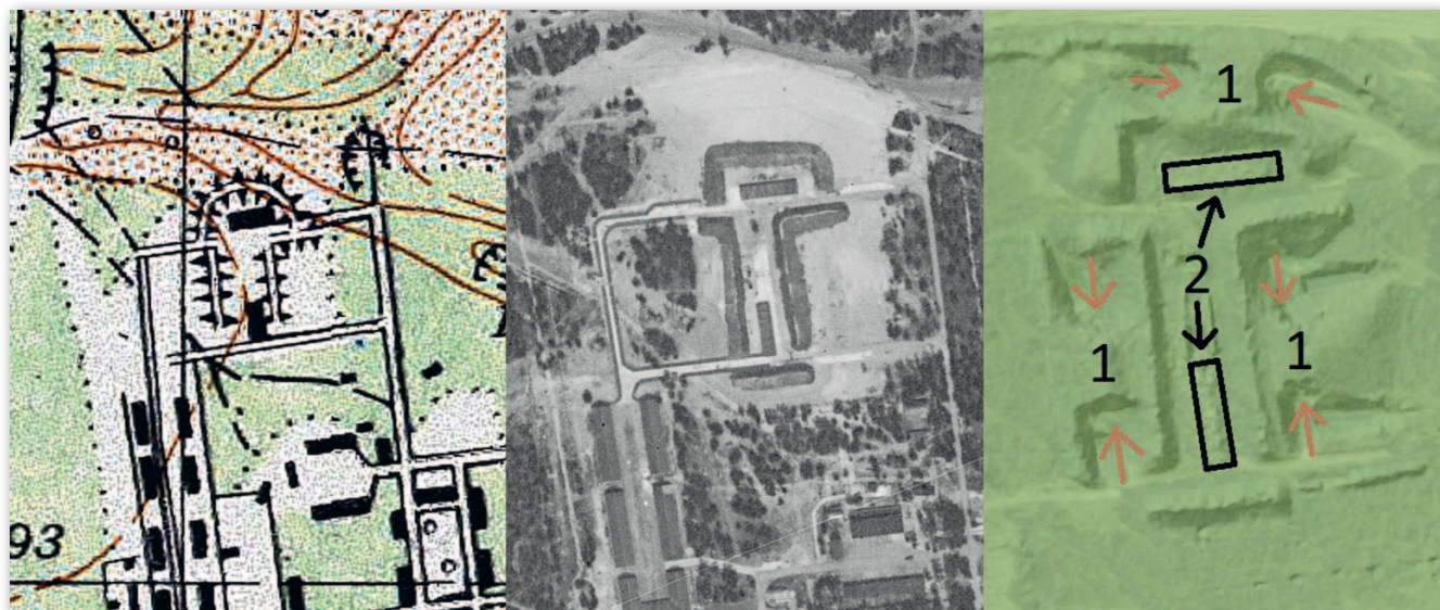
Rys. 8. Maskowanie schronu typu Granit w garnizonie Pstrąże (Strachów): fragment sowieckiej mapy w skali 1:25 000 z 1979 r., zdjęcie satelitarne z okresu budowy i późniejszy obraz lidarowy
