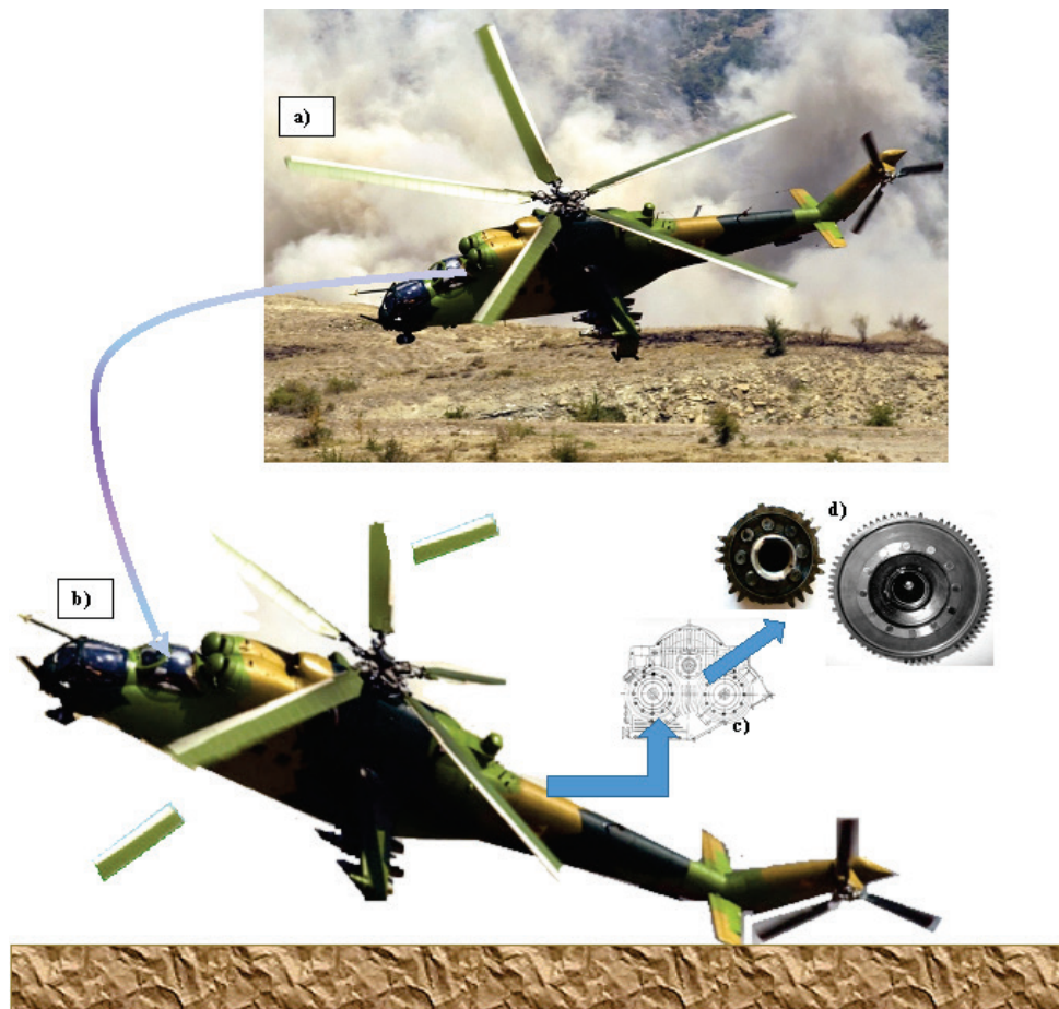
Rys. 9. Śmigłowiec Mi-24 z przerwaniem systemu transmisji w kierunku śmigła ogonowego – na skutek uszkodzenia wewnętrznego w skrzynce napędu prądnic (Afganistan 2011): a) śmigłowiec w czasie lotu – przerwanie napędu na śmigło ogonowe powoduje jego przechylenie na lewą burtę i skręt w lewo; b) śmigłowiec po zetknięciu się z płaszczyzną lotniska; c) SNA po wyrwaniu się z poszycia belki ogonowej; d) – wyłamane zęby w SNA będące przyczyną przerwania transmisji mocy do wirnika śmigła ogonowego
