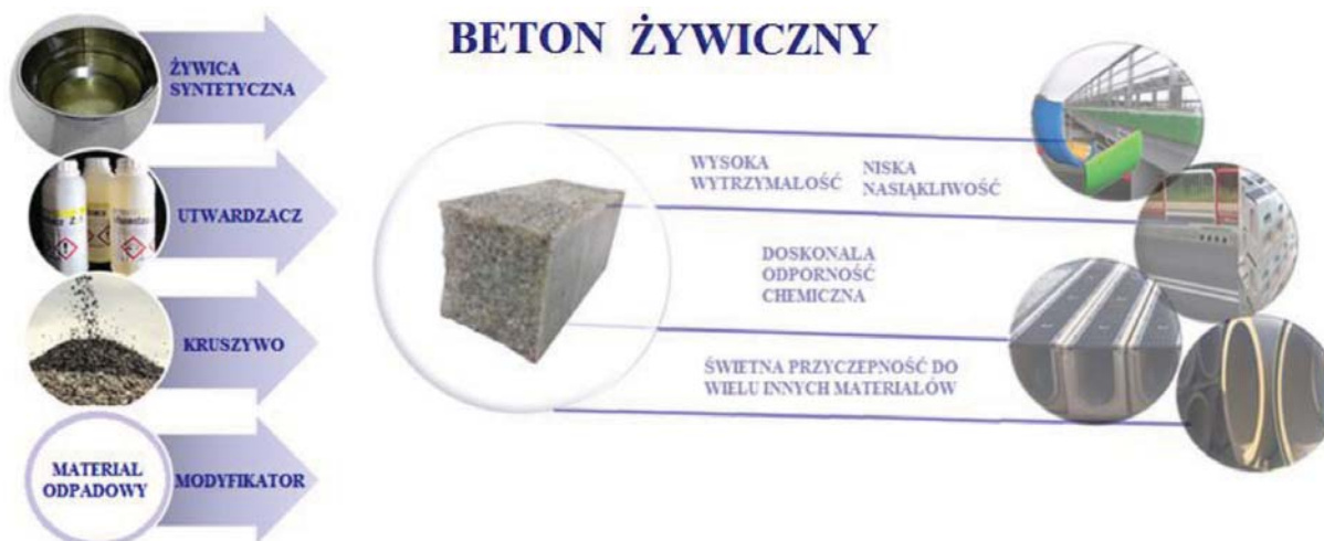
Rys. 1. Charakterystyka betonów żywicznych (polimerobetonów) (opracowanie własne)
