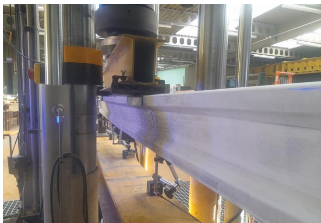
Rys. 6. Widok zniszczonej belki \Sigma 200 \times 70 \times 2 od strony środka
