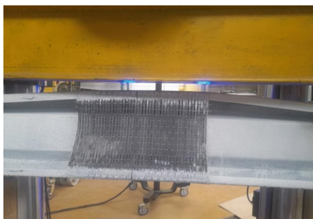
Rys. 7. Widok zniszczonej belki \Sigma 200 \times 70 \times 2 od strony wzmocnienia – deformacja przekroju w formie dystorsji
