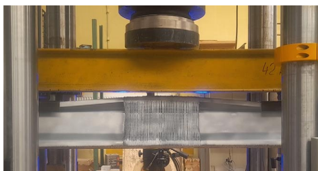
Rys. 10. Widok zniszczonej belki wzmocnionej \Sigma 200 \times 70 \times 2
