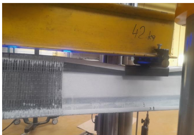
Rys. 8. Widok zniszczonej belki \Sigma 200 \times 70 \times 2 od strony wzmocnienia – lokalna deformacja w miejscach przyłożenia sił
