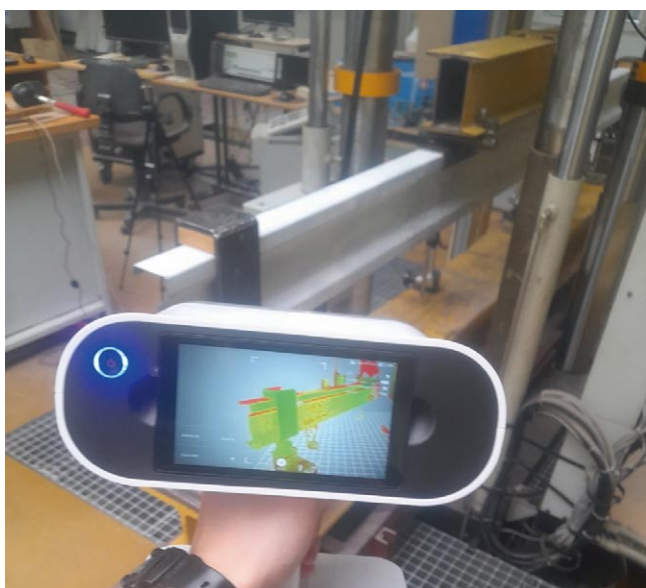
Rys. 5. Pomiar geometrii belki z pomocą skanera 3D Artec Leo
