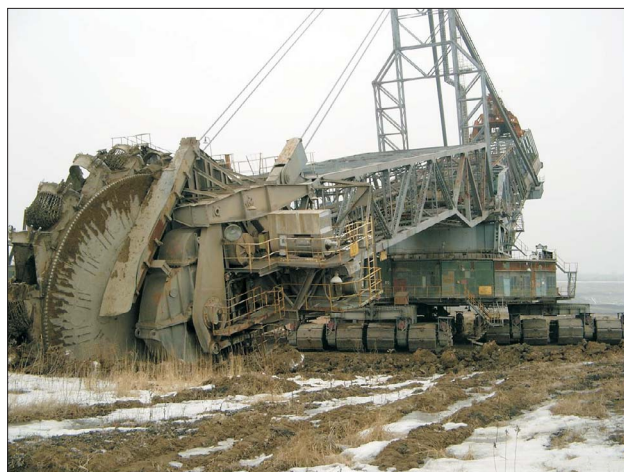
Ryc. 5. Awaria koparki SRS-2400 C Fig. 5. SRS-2400 C excavator malfunction
