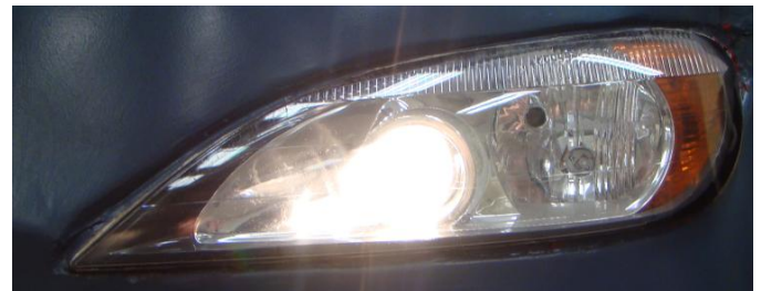
Rys. 1. Reflektor użyty podczas badań laboratoryjnych żarówek halogenowych H7 (światła mijania)
