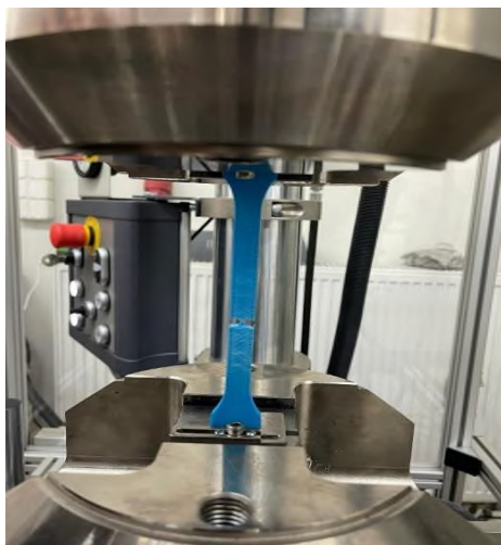
Rys. 7. Przykładowa próbka po przeprowadzeniu statycznej próby rozciągania
