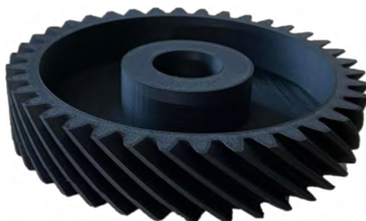
Rys. 2. Prototyp ślimacznicy wirówki oleju wykonany metodą FDM
