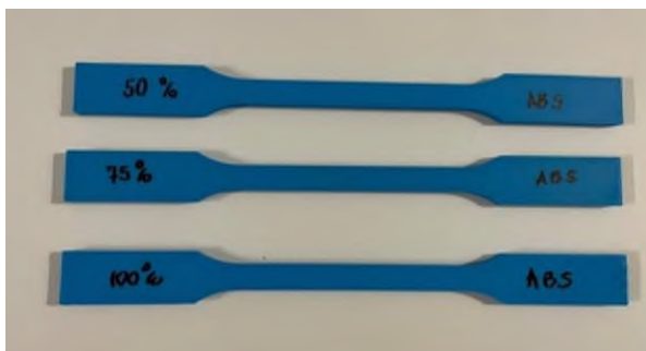
Rys. 6. Przykładowe próbki przygotowane do statycznej próby rozciągania
