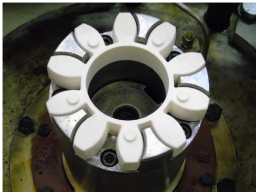
Rys. 1. Wkładka sprzęgła kłowego steru strumieniowego wykonana metodą FDM
