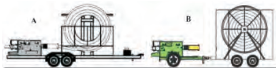
Rys. 2. Przyczepy samochodowe służące do przewożenia rur w kłębach i rozwijania ich na placu budowy
