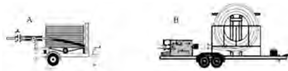
Rys. 3. Przyczepy samochodowe służące do przewożenia rur w kłębach i rozwijania ich na placu budowy
