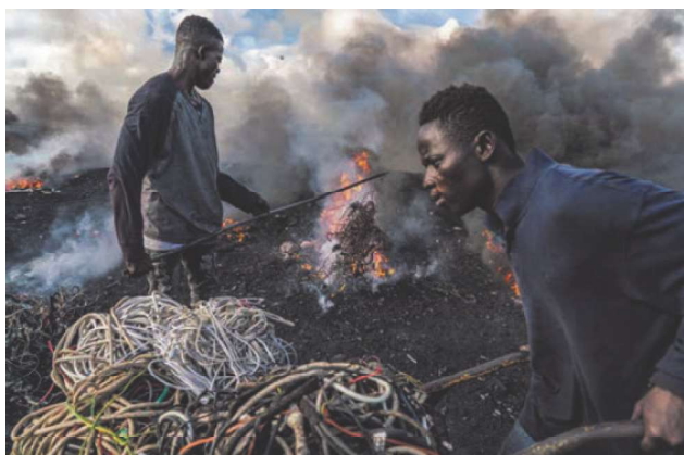
Rys. 1. Palenie przewodów elektrycznych w celu odzyskiwania miedzi, Agbogbloshie, Ghana
