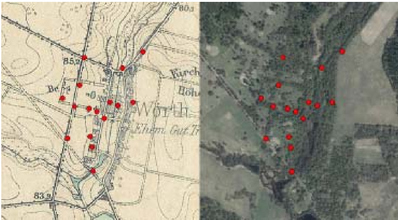
Il. 1. Punkty charakterystyczne wsi Trzuskotowo odnalezione w terenie (na czerwono), których współrzędne zapisano z pomocą urządzenia GPS, następnie wprowadzono do oprogramowania GIS. Po lewej identyfikacja punktów według mapy historycznej z 1911 r. ( http://mapy.amzp.pl ), po prawej dla porównania stopnia przekształcenia krajobrazu aktualna ortofotomapa tego terenu ( http://mapy.geoportal.gov.pl )
