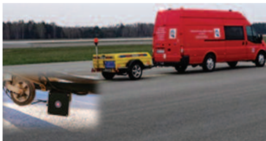
Photo 2. ASFT tester on a T-10 trailer Fot. 2. Tester ASFT na przyczepie T-10
