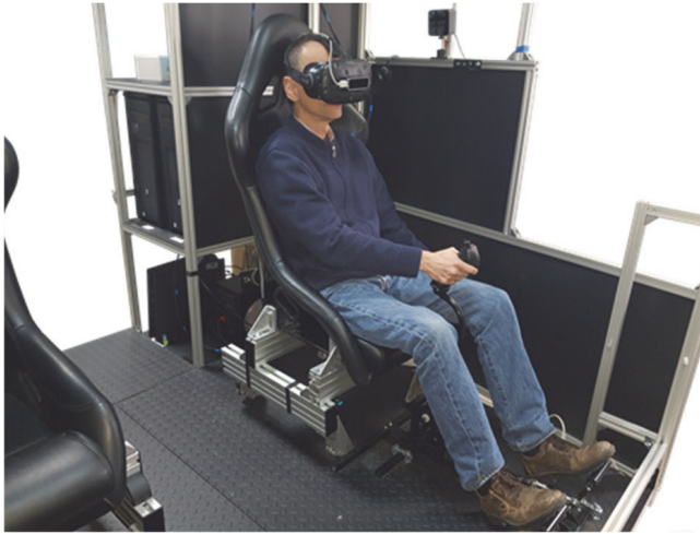
Fig. 3. Cockpit simulator in MR technology Rys. 3. Symulator kabinowy zrealizowany w technologii Mieszanej Rzeczywistości
