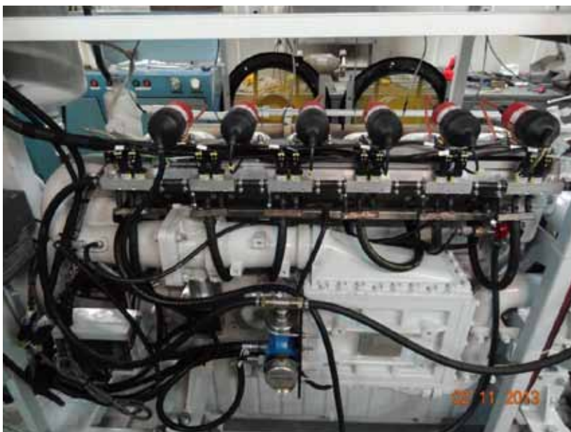
Rys. 3. Silnik MAN E2876 LE302 na stanowisku laboratoryjnym Politechniki Krakowskiej
