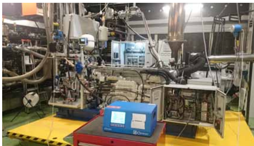
Rys. 2. Agregat prądotwórczy z silnikiem przystosowanym do zasilania paliwami gazowymi na stanowisku laboratoryjnym firmy Horus Energia
