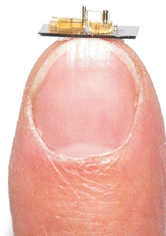
Rys. 7. Mikrosilnik tłokowy SU-8 sfotografowany na palcu. Wszystkie element wykonano z wykorzystaniem technologii UTSP (oprócz dwóch czopów)
