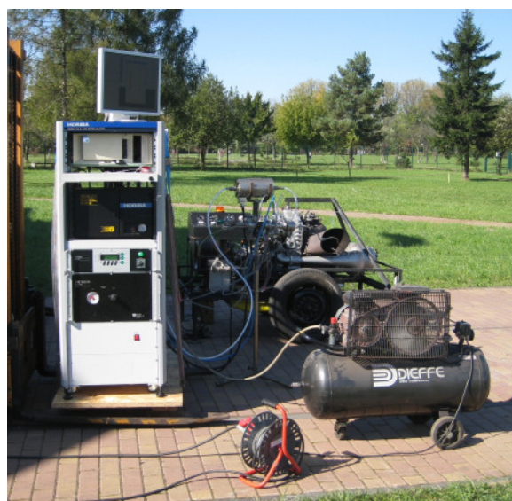
Rys. 2.5. Widok ogólny stanowiska pomiarowego z silnikiem GTD-350. Widoczny analizator Horiba TEOM 1105 oraz sprężarka powietrza zasilająca mini-tunel rozcieńczający (MDT) Fig. 2.5. Plan view of the measuring stand with GTD-350 engine. Visible: Horiba TEOM 1105 analyzer and the air compressor for feeding the Mini Dilution Tunnel (MDT)
