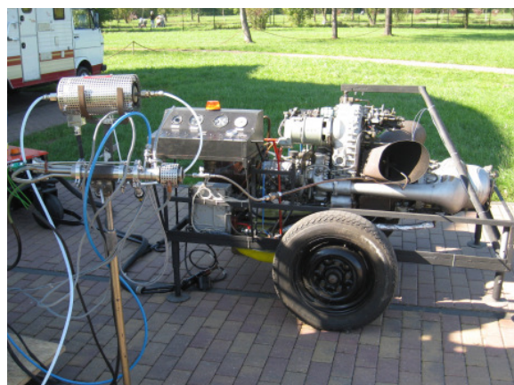
Rys. 2.6. Silnik GTD-350 wraz z mini-tunelem rozcieńczającym; widoczna sonda spalin Fig. 2.6. GTD-350 engine with Mini Dilution Tunnel; visible the exhaust gas sampling probe
