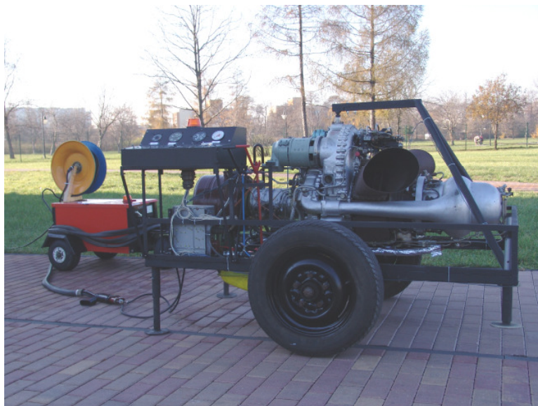
Rys.2.1. Mobilne stanowisko pomiarowe z silnikiem GTD 350, widoczny zasilacz rozruchowy Fig. 2.1. Mobile measuring stand with GTD-350 engine; visible electric starting feeder
