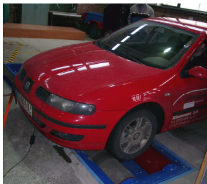
Rys. 2.1. Pojazd Seat Toledo 1.9TDi na hamowni podwoziowej LPS 3000 MAHA
