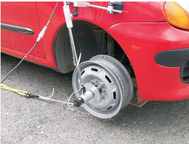
Fig. 6. View of the wheel rim with the speed sensor Rys. 6. Obręcz koła z czujnikiem prędkości obrotowej
