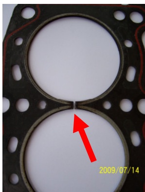
Fig. 1. The defected head gasket Rys. 1. Uszkodzona uszczelka głowicy
