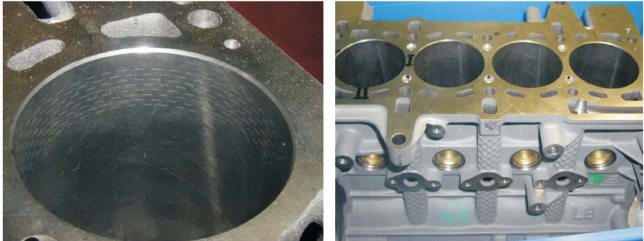
Rys. 5. Zdjęcie 4-cylindrowego bloku silnikowego po obróbce laserem według technologii firmy Gehring Fig. 5. The picture of the 4-cylinder engine block after the laser treatment under the Gehring company technology
