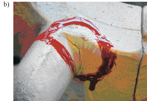
Rys. 1. Pęknięcia wykryte w elewatorach: a) dwa pęknięcia zawiasu, b) pęknięcie rączki
