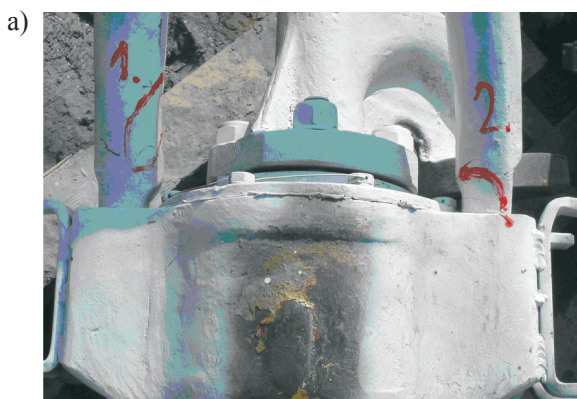
Rys. 2. Pęknięcia wykryte w głowicach płuczkowych: a) dwa pęknięcia kabłąka, b) pęknięcie korpusu
