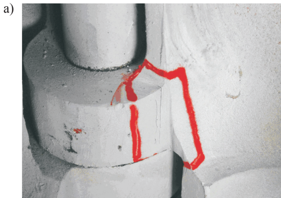
Rys. 1. Pęknięcia wykryte w elewatorach: a) dwa pęknięcia zawiasu, b) pęknięcie rączki
